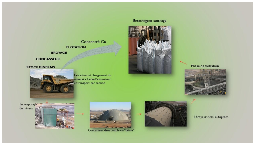
Photo 9 : Procédé de traitement du minerai de cuivre-or d'Akjoujt (source : MCM, 2022)
