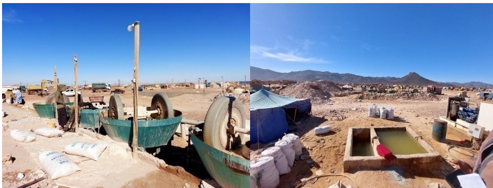
Photo 14 : Equipements de traitement de minerai pour extraire l'or dans les centres de traitements artisanaux
