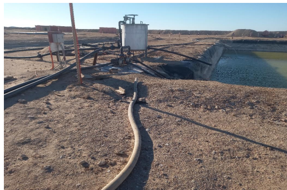
6. Les résidus sont recueillis dans les Tailing dam (fosse de déchets ou de résidus) qui constitue le circuit final du processus.
