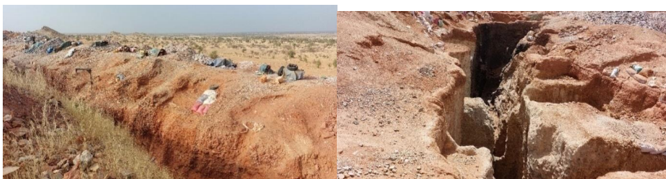
Photo 18 : Sites d'extractions : excavations étroites, profondes sans respect des normes de sécurité
