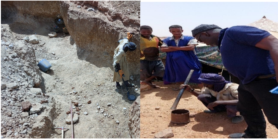
Photo 16 : Recherche d'or natif de surface à l'aide de détecteurs à métaux, creusement de fosses peu profondes pour prélèvement d'or visible ; paysage remanié en « terriers d'écureuils ».
